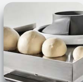
Salida bola en bandeja superior y redondea de 20 gr. a 900 gr.
